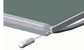
KAPAK İÇ CAMI SÖKÜLMESİ
